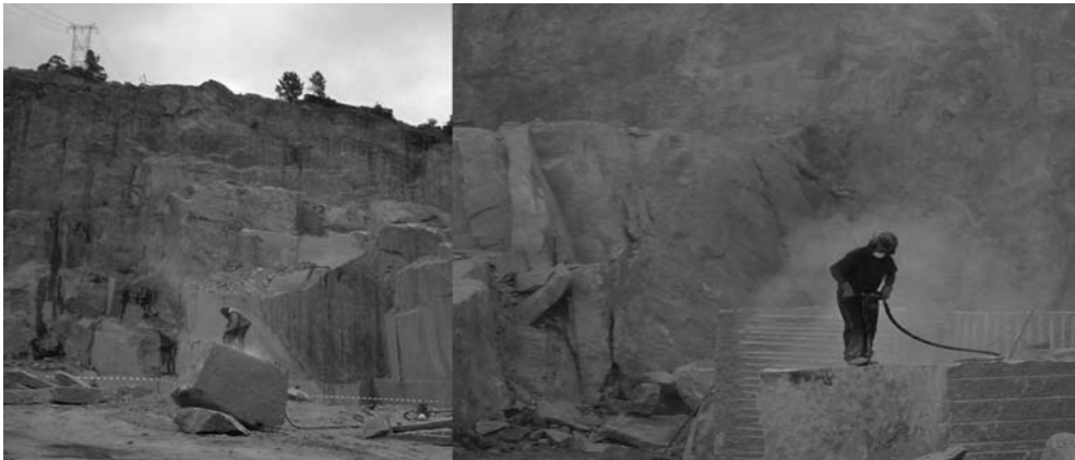
FIGURA 1. Explotaciones a cielo abierto, sin medidas de captación de polvo.
